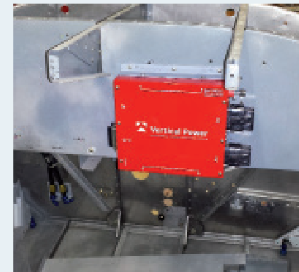
Oben links: Midget Mustang. Oben rechts: Vertical Power electronic circuit breaker management system (Elektronische Überwachung und Steuerung des elektrischen Systems). Grosses Bild: Vari Eze. | En haut à gauche: Midget Mustang. En haut à droite: Vertical Power electronic circuit breaker management system. Grande image: Vari Eze.
